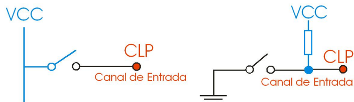
Figura 2.4: Exemplos de Interruptores
